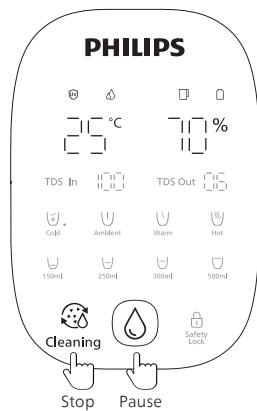
(5) Når "100 %" blinker, er rengøringsprocessen slut.
